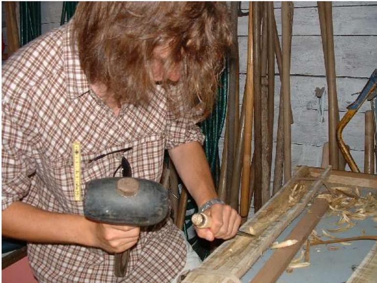
**Illustration 10:** Ausbeiteln der Rohlinge. Wenn möglich wurden zur Fixierung Spanngurte verwendet, die das Holz nicht beschädigen.
